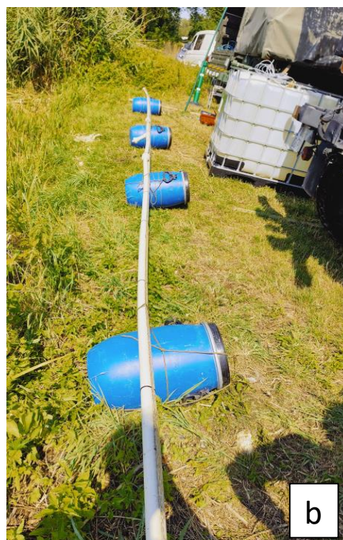
Fot. I.3. Instalacja dozująca, przed zamontowaniem w nurcie rzeki: a) zbiornik ruchomy z perhydrofluem wraz z dyszą dozującą rozmieszczoną na pływakach; b) beczki, pełniące rolę pływaków umożliwiających zamontowanie dyszy dozującej na pożądanej głębokości (fot. Ł. Weber, data 26.07.2024 r.).
