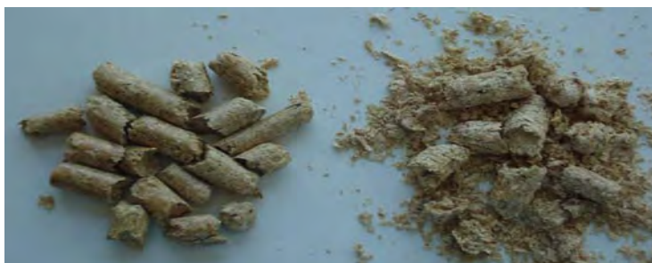
Rys. 5. Biomasa w formie peletów (na lewo) oraz pelety po ekspozycji na wilgoć (po prawej)
