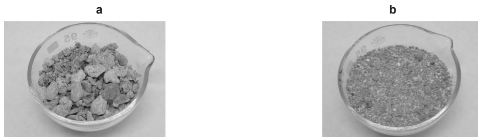
Rys. 2. Pozostałości po spalaniu odpadów komunalnych w piecu rusztowym: a – żużel (ŻW), b – popiół (PW)
